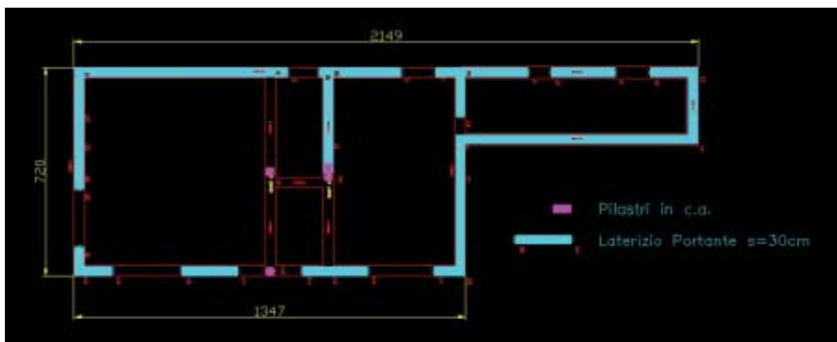
Fig. 2 - Dettaglio dimensionale del fabbricato (misure in cm).
